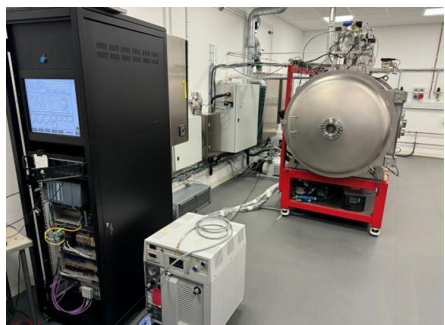
PECVD (プラズマ励起化学気相成長法) 実験装置
