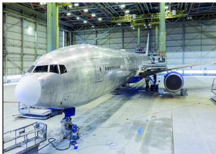
塗装を除去した 修理中の機体
