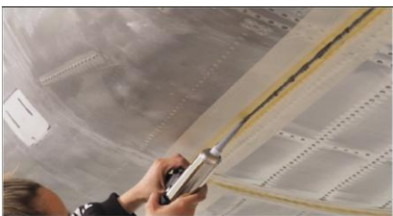
シーラントの塗布
