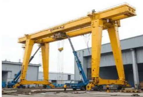
ガントリークレーン
