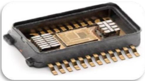
加速度検知センサー
