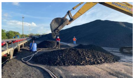
石炭処理プロセス（粉塵飛散防止、自己燃焼防止）
