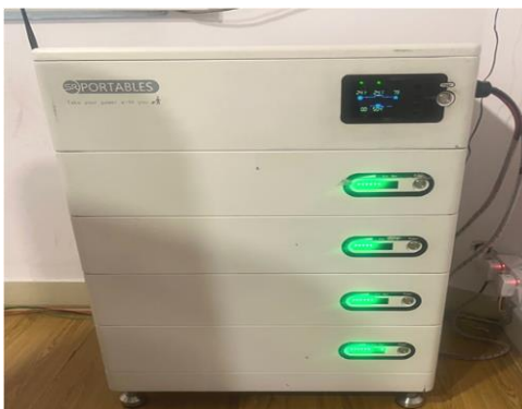
サンパワー製オフグリッド インバーター・バッテリー
