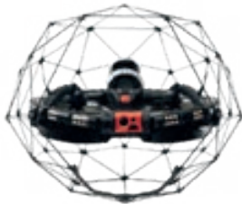
閉所用ドローン(スイス製)
