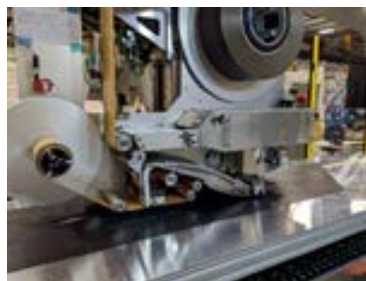
構造体・機体パーツ用 複合テープ積層機
