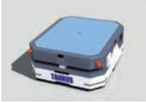
当社が開発した物流倉庫内 自律移動ロボット“Taurus”。
