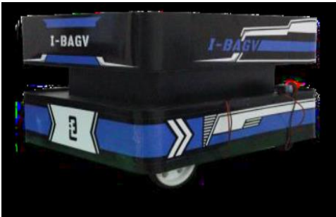
当社製AIナビゲーション搭載AGV（可搬重量100kg）
