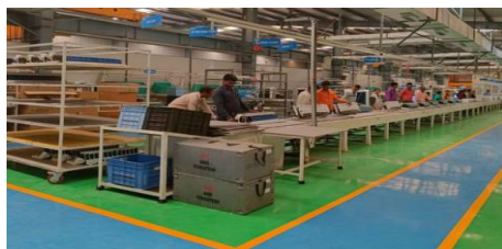
エアコン室内ユニット (IDU) の組み立てライン
