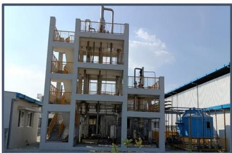
マルチエフェクトエバポレーター (MEE)、および攪拌式薄膜乾燥機 (ATFD)
