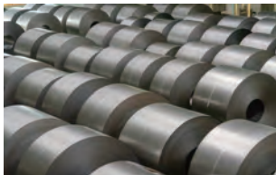
出荷前の熱延鋼板コイル
