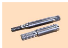
農機具用スプライン軸 ・旋盤→歯切り →高周波焼入れ→研磨
