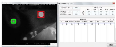
RekamoSTソフトウェア画面 左：溶接スパッタ補足、右：特徴量一覧
