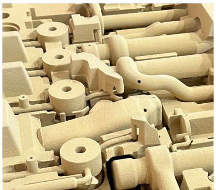
Noyaux de moule en sable fabriqués avec une imprimante 3D
