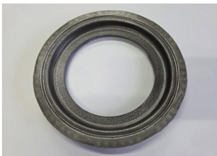
Bague étagée (ne peut être fabriquée par forgeage par laminage)
