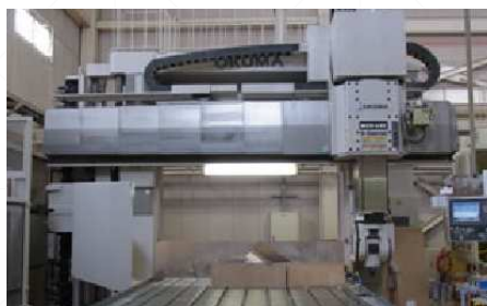
門型5軸加工機 OKUMA MCR-A5C X4000/Y2000/Z800
