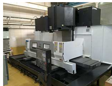
縦型加工機 OKUMA MILLAC 1052V X2000/Y1000/Z800
