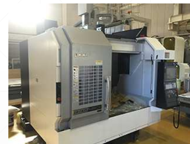
縦型加工機 OKUMA M560V X1000/Y560/Z460
