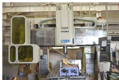
門型加工機 OKUMA MCV-A2 X1800/Y1400/Z800
