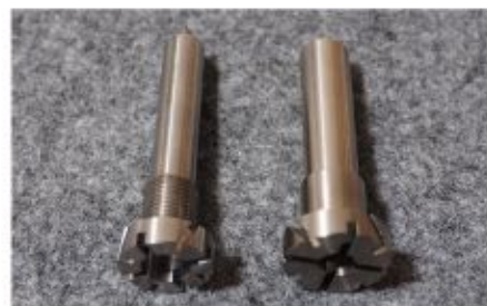
素材:S45C 製品名:電着工具 台金
