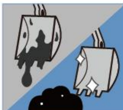
バケットへの付着軽減、施工性向上
