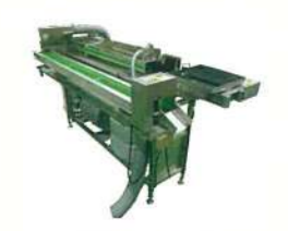
卵を搬送しながらスパイラルブラシが高速回転し満遍なく洗浄する
