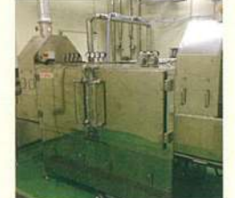
凝縮伝熱(蒸気の凝縮)により大量の熱を与え短時間で殺菌する
