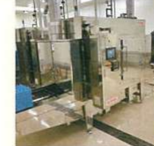
アメリカントレーに載せた状態で加工できヒートショックの影響が少ない
