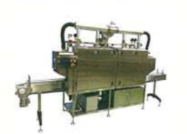
過熱蒸気を熱源にすることで収縮性と省エネに優れ、さらに小型化した
