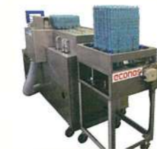
特殊ノズルによる抜群の洗浄効果で水切り装置も装備する
