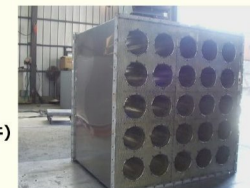
仙台市 (3) 空調ダクト用消音器(一部)
