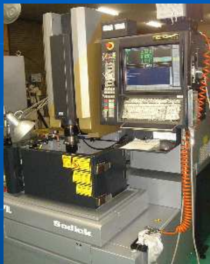
形彫放電加工機 (TBK/TBT) (ソディック製AP1L リニア駆動)
