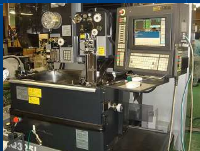
ワイヤーカット放電加工機 (TBK/TBT) (ソディック製AQ325L リニア駆動)
