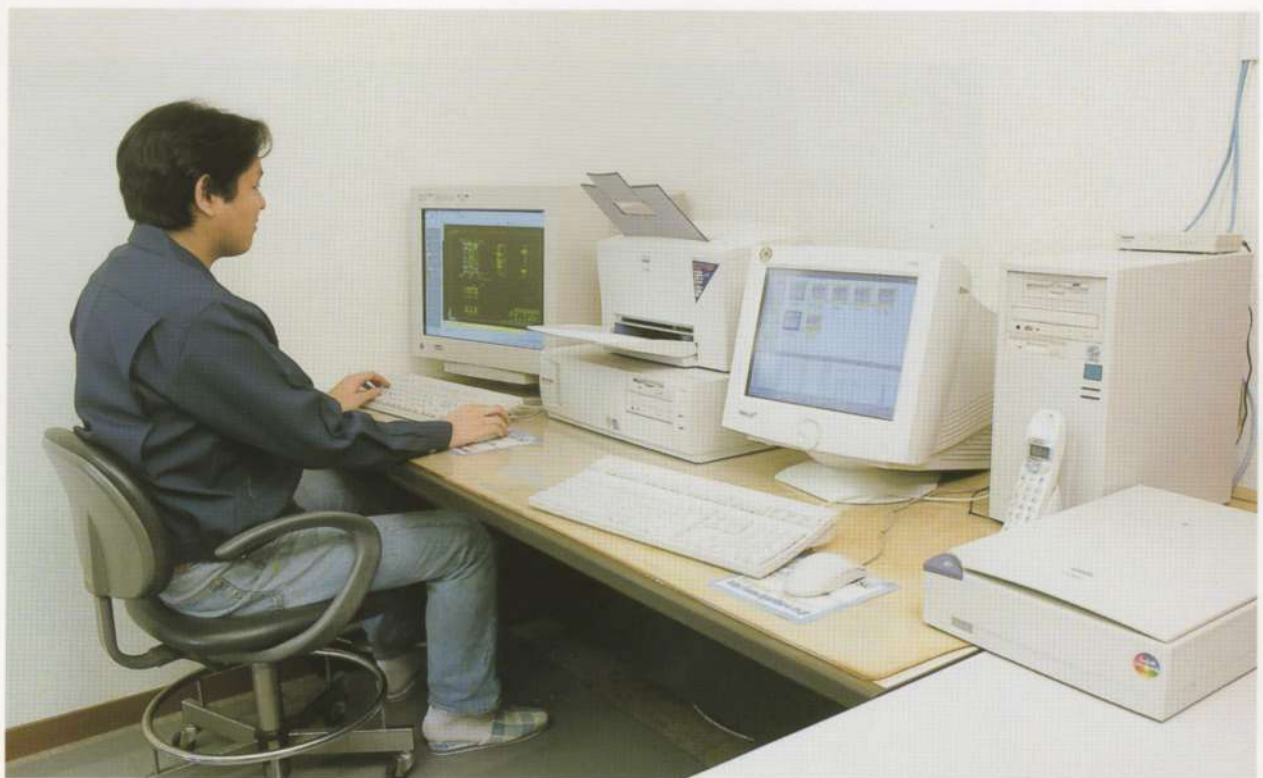
▲CAMとデータ管理システムの連携で全てのNC機械はDNC運転が可能です
