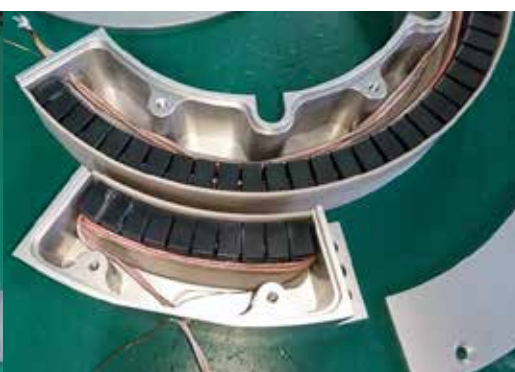
二重リング形状でのセンサ 給電 (20W+ 接点信号)
