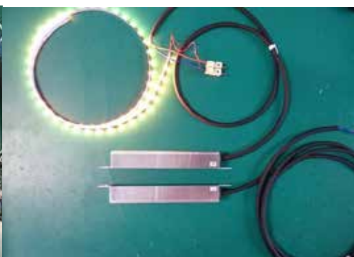
ドアへの給電 (10W+ 制御信号)
