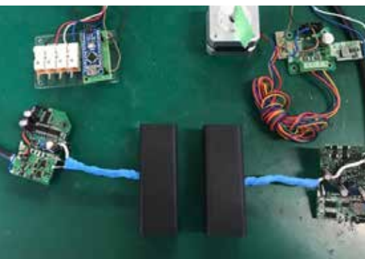
ステッピングモーターへの給電 (数 W+ パルス信号)
