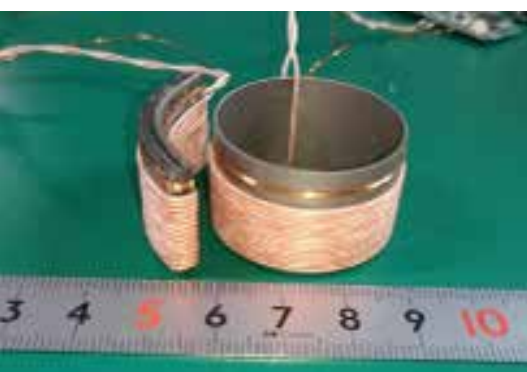
小型コイル形状でのセンサ給電 (1W+ シリアル通信)
