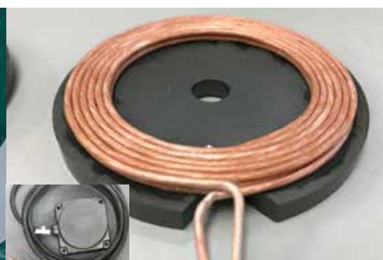
小型ヘッドでの PC 電源給電 (80W)
