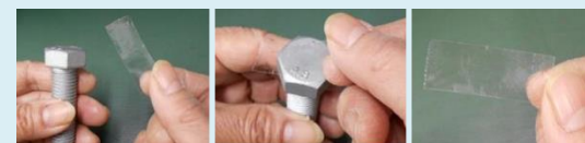
密着性確認の剥離試験
