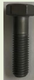
①遅れ破壊試験後
