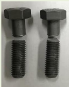
①遅れ破壊で折れたボルト
