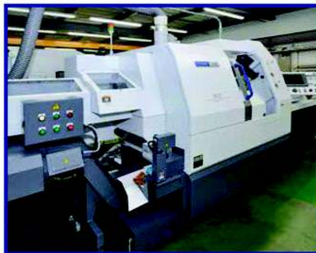
CNC 自動旋盤 M32VIII シチズンマシナリー 10軸制御 加工径φ4～φ20
