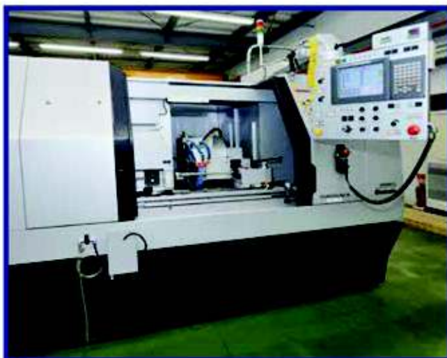
NC 精密円筒研削盤 OGM250UNC III 岡本工作機械製作所 φ150×L500
