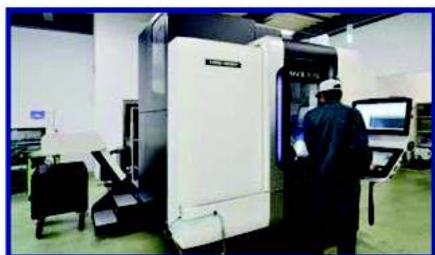
立形マシニングセンタ NVX5060/40 DMG 森精機 テーブル : 600×400×300 回転数 : 15,000rpm
