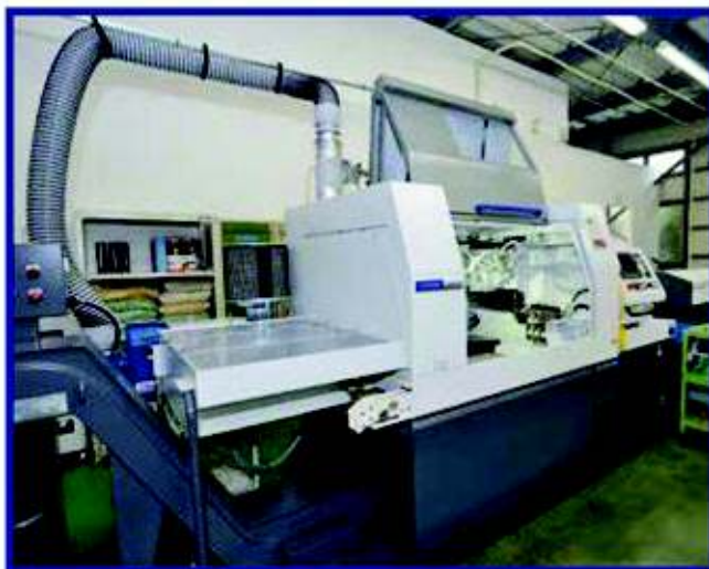
CNC 自動旋盤 L32X シチズンマシナリー 加工径φ6～φ32
