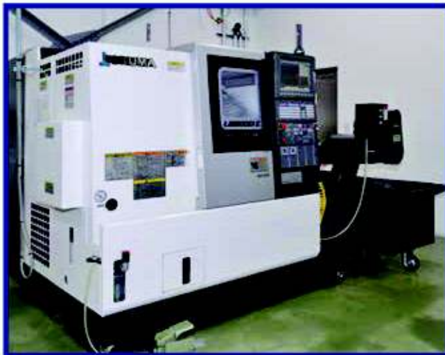
CNC 自動旋盤 LB2500EX II オークマ 加工ワーク：～φ150×L250
