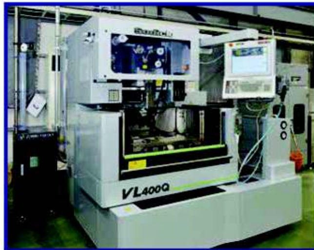
ワイヤー放電加工機 VL400Q ソディック テーブル：350×250×170
