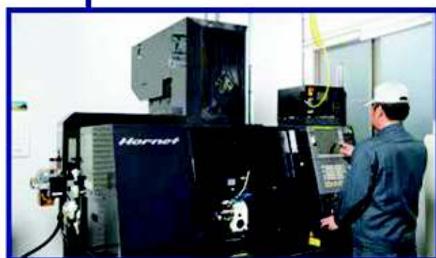
超精密微細加工機 Hornet 碌々産業 穴径 : \phi 0.05 \sim \phi 5.0 回転数 : 40,000rpm
