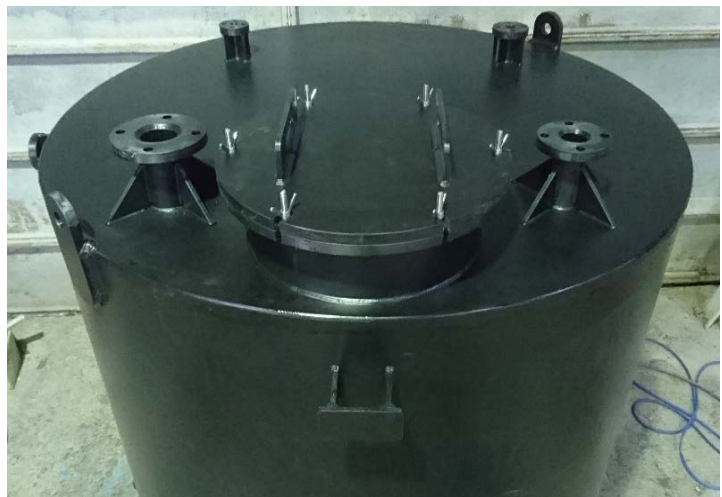
薬品貯槽 黒 HDPE
