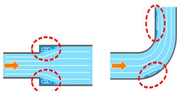
配管接続部の乱流発生を抑える
