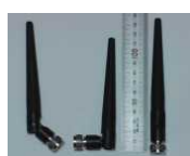
屈曲型スリーブアンテナ G=2dBi
