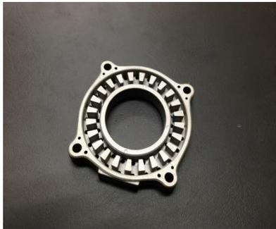
近年、情報機器、電子機器、医療機器をはじめとする製品の小型化・高性能化によって、部品の高精度化・複雑形状化の流れがますます進んでいます。弊社では複雑な形状の加工を実現できるメタルインジェクションモールドの中国調達をお手伝いいたします。メタルインジェクションモールドMIMとは粉末状の金属粉とバインダーを混ぜ合わせ、金型に射出することによって目的の形状の金属部品を作成する加工方法です。量産化に適したこの成型方で製品のコストダウン、新規部品の設計などにお役立ち出来ればと考えています。
