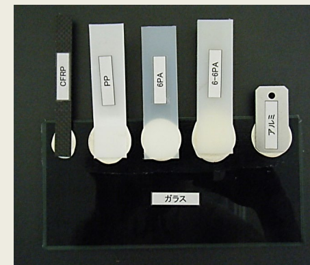
ガラスと各樹脂との接着模様 (変性シリコン接着剤使用)
