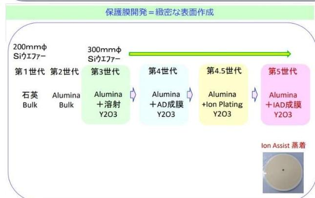
最先端プロセスのRFウィンドウ（アルミナ基板）保護膜形成技術はイオンアシスト蒸着法（IAD）によるY<sub>2</sub>O<sub>3</sub>コートが主流です。IAD法による膜質は溶射、エアロゾル蒸着（AD）、イオンプレーティング（IP）による成膜よりも耐プラズマ性・耐食性に優れています。
