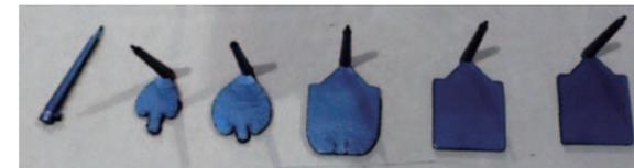
同一の樹脂でも、成形条件や金型の形状で熱伝導性が変化します。
