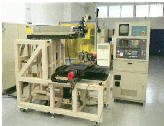
YAGレーザー加工機外観 薄板溶接、切断、穴あけが可能
