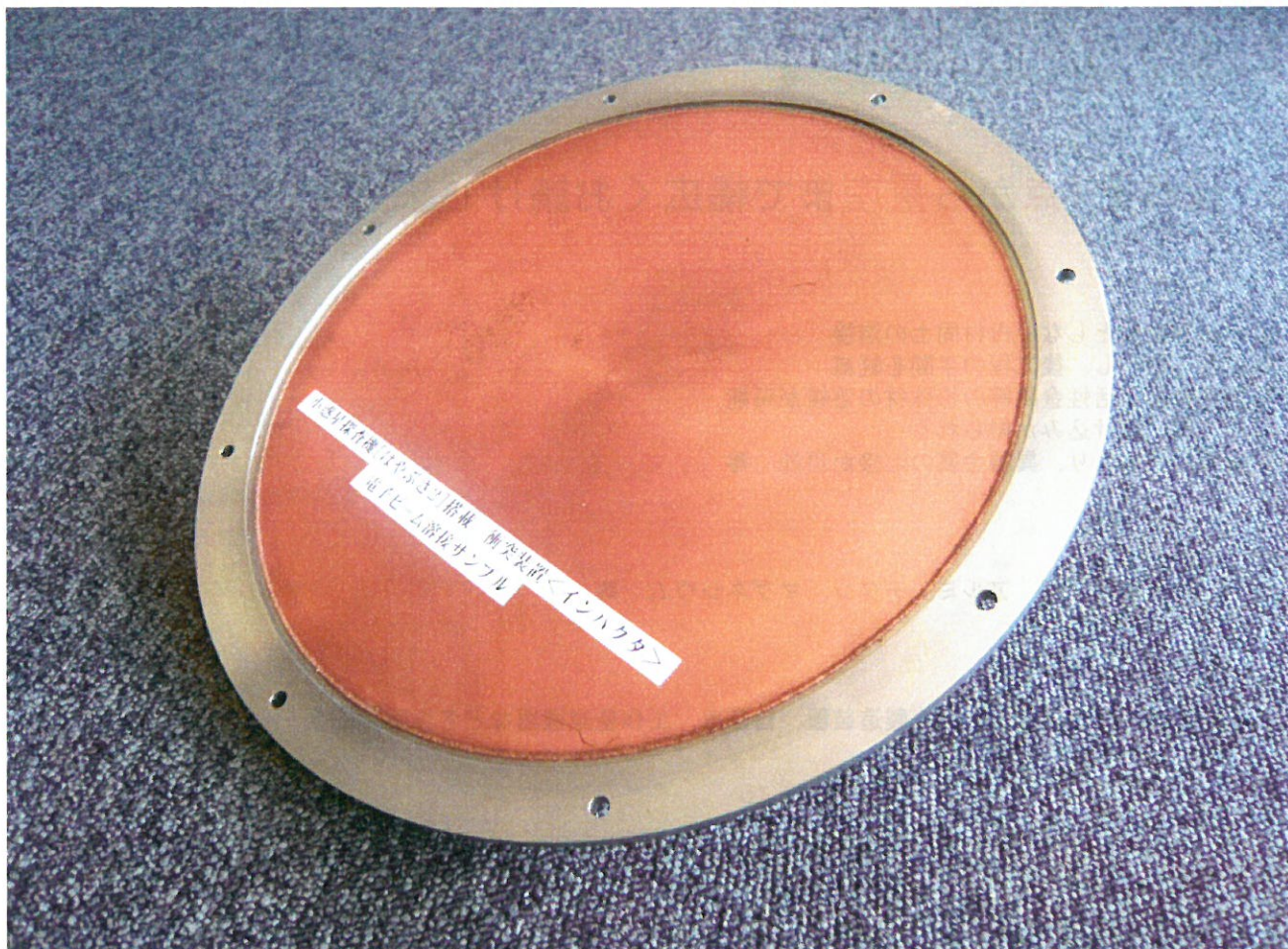
はやぶさ2搭載「インパクト」溶接サンプル(Cu1020+SUS304)
