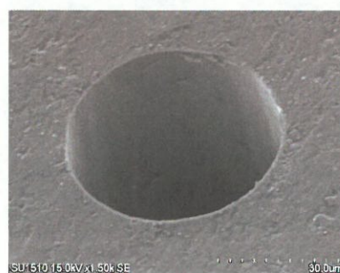
材質:SUS 板厚:100 \mu\text{m} 穴径:40 \mu\text{m}
