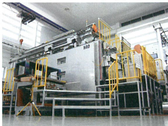
電子ビーム溶接機外観 チャンバーサイズ(mm) X4,500 Y:3,100 Z:1,400 深溶け込み、異種金属溶接が可能
