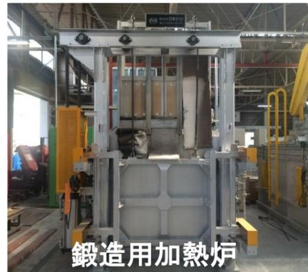
鍛造用加熱炉
