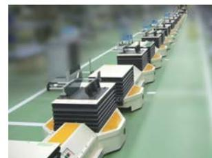
RGVとは、床に設置された軌道レールから電源供給を受け、且つガイドに沿って自走する有軌道無人搬送台車です。AGVに対してRGVはバッテリー交換、または充電が不要でガイド走行を行うためAGVに比べて横揺れがなく高速な走行が可能です。工場内のフレキシブル・マニュファクチャリング・システム化や自動化を物流の面で支え、生産ラインの効率化を図ることができます。
