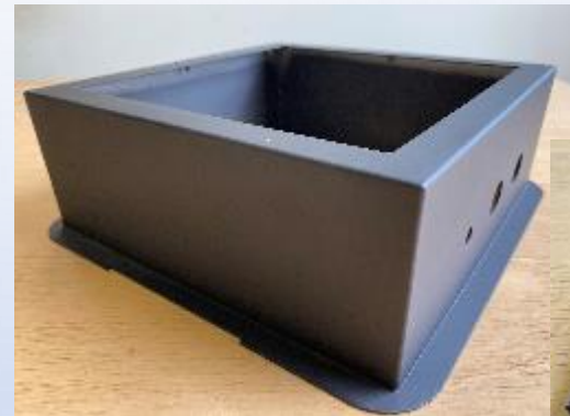
SPCC 1.6 t 溶接構造
