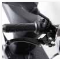
パーキングブレーキ 坂道停車に役立つパーキングブレーキを前後輪に搭載
