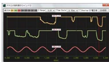
高速カメラ画像と波形を同期記録する総合ロガーシステム(Proのみ) 画像と波形を連動させながら、原因解析。各種波形を記録トリガにもできます。
