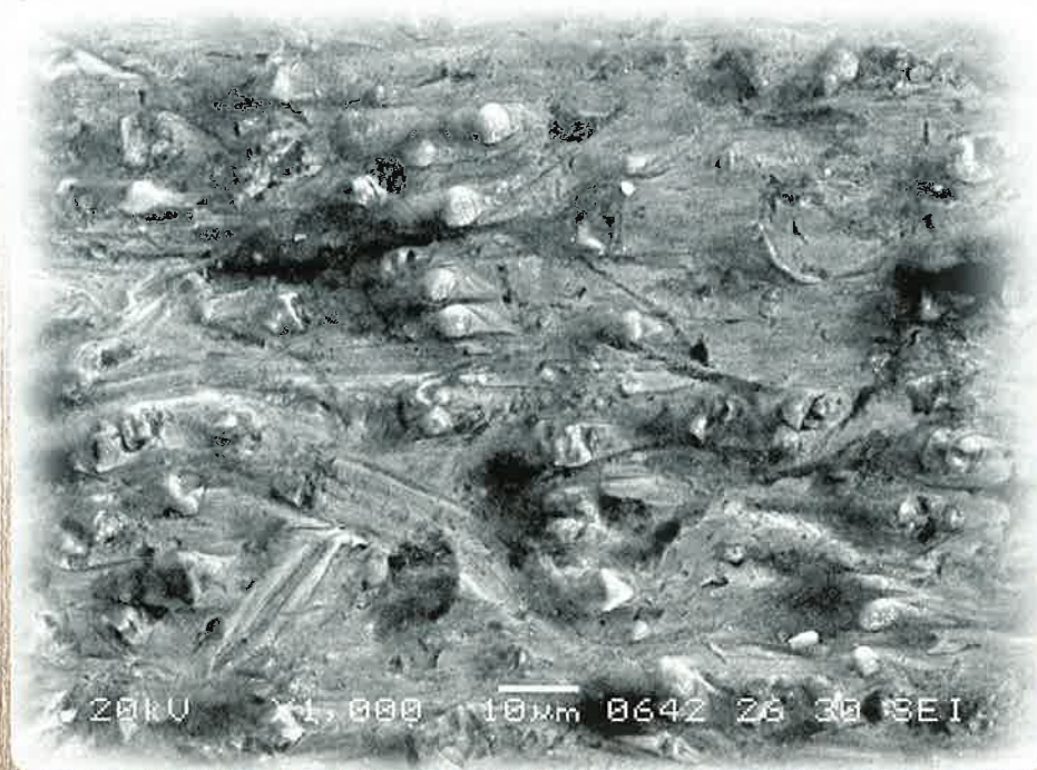
この写真は摩耗試験後に撮影したECORRの表面状態です。
