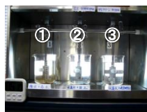
攪拌5分 海水＋赤土も 凝集沈殿。
