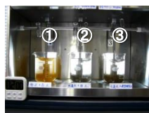
攪拌2分 田土、建設発生土 ともに凝集沈殿。
