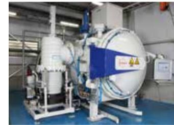
〈最先端〉真空熱処理炉
