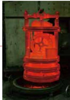
〈ピット型〉浸炭雰囲気炉
