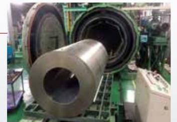
〈大型1室〉真空熱処理炉
