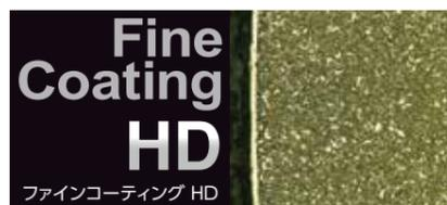
ファインコーティングHD(hybrid diffusion)は、新開発の母材強化とそれに最適化したファインコーティングVCを融合させた画期的なセラミックコーティングです。ハイテン(高張力鋼板)材のプレス加工時に現れるセラミック被膜直下からの剥離を抑制するため、密着性を大きく改善した処理です。
