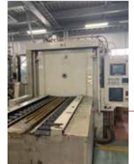
〈真空浸炭・油冷〉真空熱処理炉
