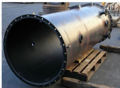
● 水処理装置樹脂塔ゴムライニング
