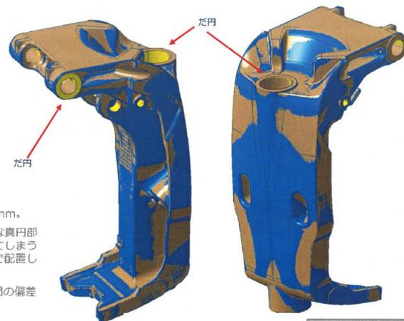
右図モデルの偏差量は0.1mm~1.3mm。
