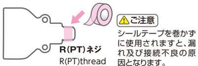
相手側 (メネジ側) に手で仮締めし、スパナ等で締め込んでください。
