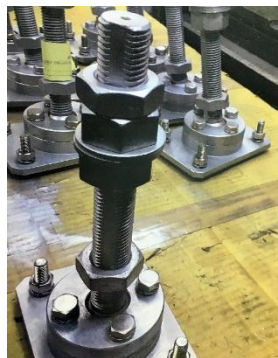
アンテナ支持ボルト
