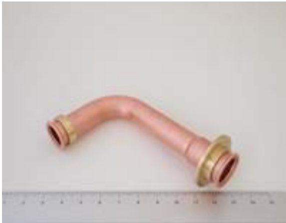
製品名： 給水接続管 素材： C1220 T-O/C3604BD サイズ： φ14/R20/t0.7
