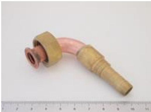
製品名： 給水接続管 素材： C1220 T /C3604BD サイズ： φ10/R15/t0.8
