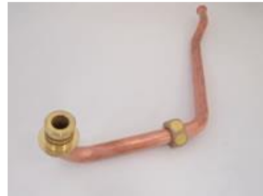
製品名： 給水接続管 素材： C1220 T /C3604BD サイズ： φ10/R15/t0.8
