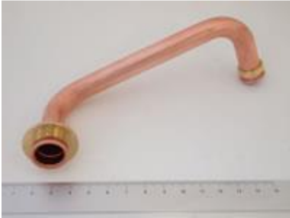
製品名： 給水接続管 素材： C1220T-O /C3604BD サイズ： φ14/R20/t0.7
