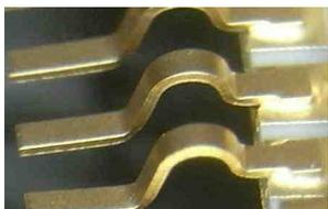
Ω型曲げリードの加工例
