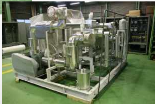
バイオマスガス冷却ユニット
