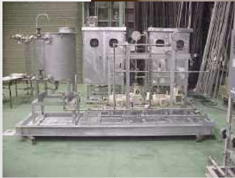
薬液注入 ユニット
