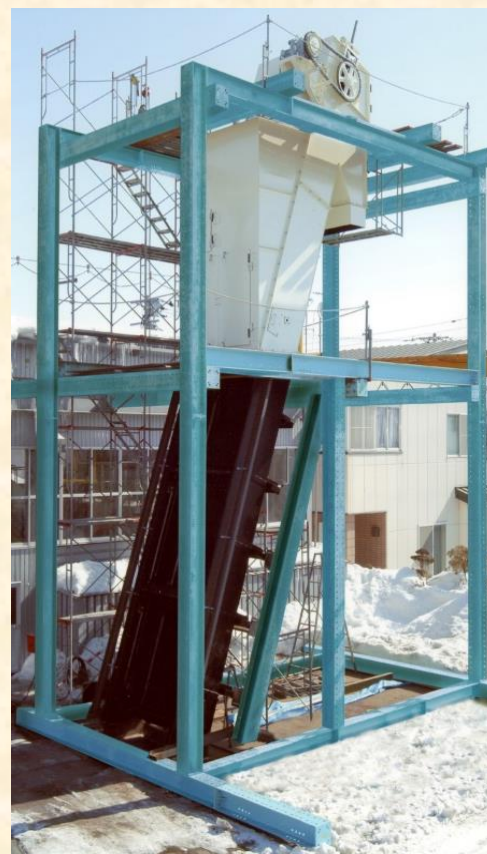
水処理場向/除塵機(下部仮組時)
