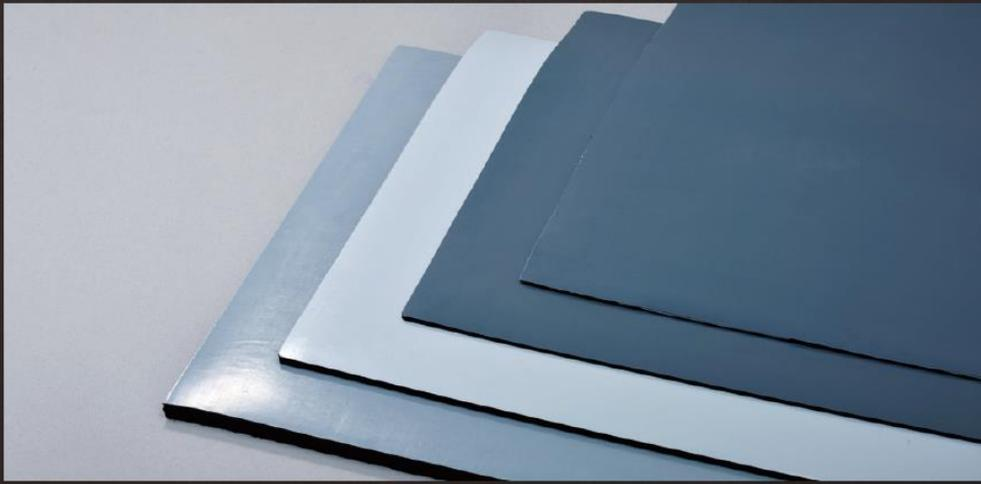
ハネナイト®の表面粘着対策・耐摩耗性改善品として、ハネナイト®の表面にテフロンフィルムを加硫接着したシートを用意しました。加硫接着のためハネナイト®とテフロンフィルムの接着強度は一般的な両面テープ・接着剤での接着時の約3倍です。
