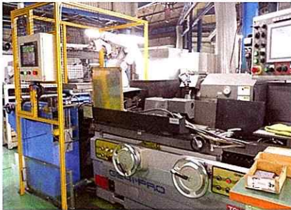
豊田工機 CNC円筒研削盤 GE4i-PRO 2台
