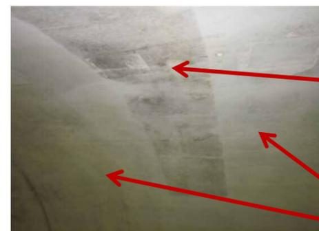
養生終了時、LHTシートを剥がした後のコンクリート面です。保水量の大小により、黒い濃淡が確認できます。
