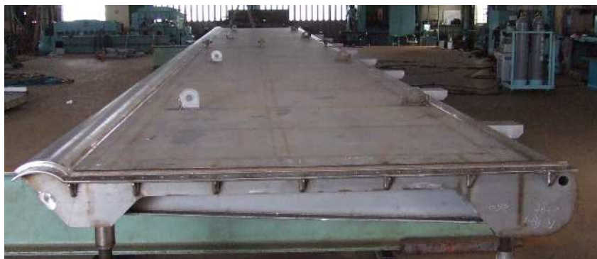
日立造船鉄構(株) (鹿児島県加世田土木事務所) 鹿児島県枕崎市 転倒ゲート 2.0m×18m 1門
