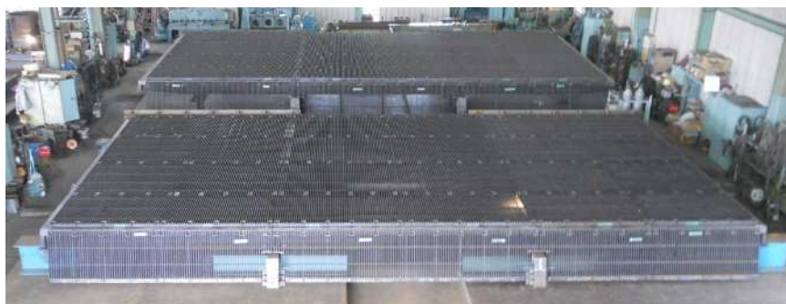
日立造船(株)【中国電力(株)】 島根県飯石郡飯南町 潮発電所 スクリーンパネル、受桁 12.6m×6.2m 2連
