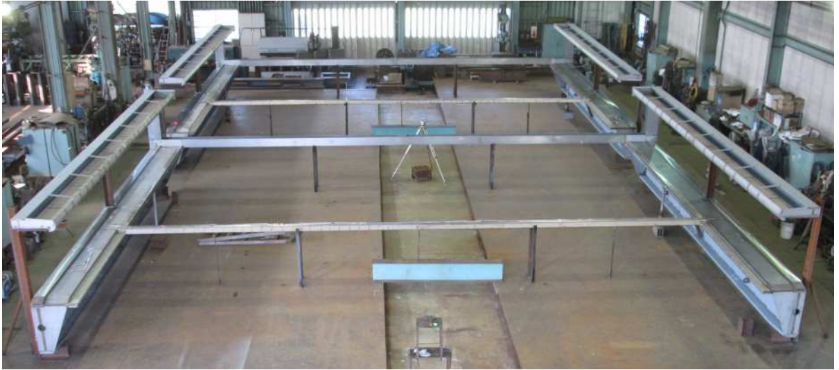
日立造船(株)【東北電力(株)】 新潟県 鹿瀬発電所 放水路制水門 スライドゲート戸当り 10.48m×4.945m 2門
