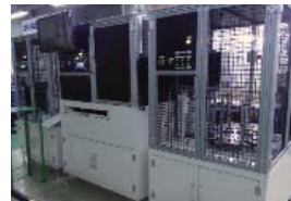
【金属加工品検査装置】 カケ、未加工などの検出
